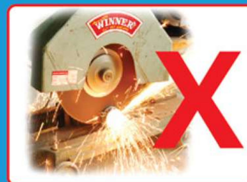
ห้ามใช้เลื่อยไฟเบอร์ตัดท่อไชเลอร์
