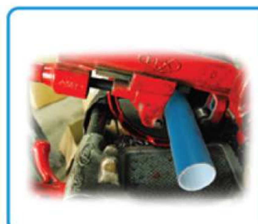
ใบมีดในเครื่องตัด (Roller Cutter)
